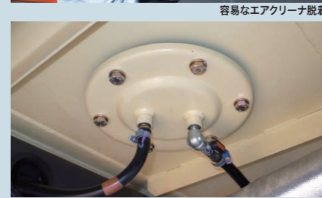
内部を清掃しやすくなった燃料タンク
